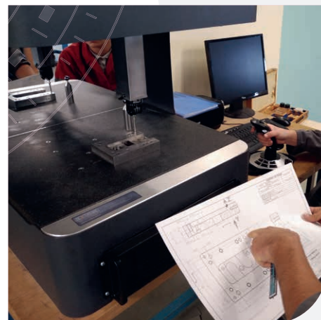
Qualification de pièces par contrôle sur Machine à Mesurer Tridimensionnelle (MMT)
